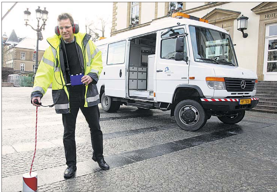
Wassermeister Roger Schlechter vom städtischen „Service de l'eau“ führt vor dem neuen Lieferwagen die Bedienung eines Mikrofons zum Aufspüren von Leckagen im Trinkwassernetz vor.
